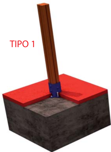
FIJACION A SOLERA DE HORMIGON
