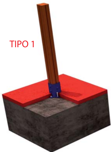
FIJACION A SOLERA DE HORMIGON
