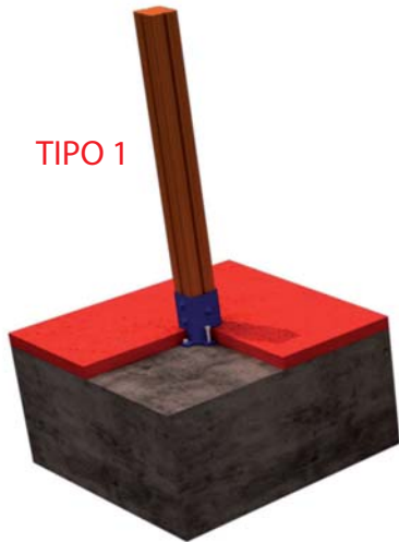
FIJACION A SOLERA DE HORMIGON
