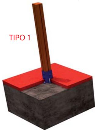
FIJACION A SOLERA DE HORMIGON
