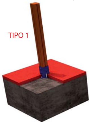
FIJACION A SOLERA DE HORMIGON
