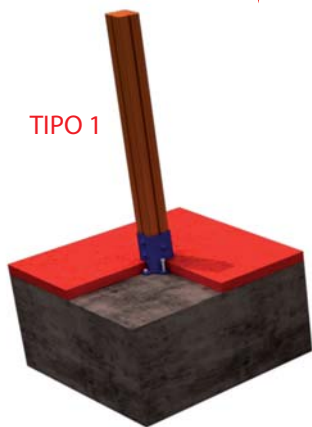
FIJACION A SOLERA DE HORMIGON
