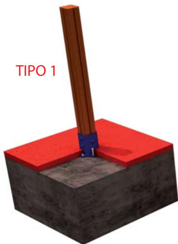
FIJACION A SOLERA DE HORMIGON
