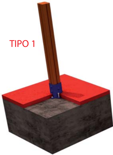
FIJACION A SOLERA DE HORMIGON
