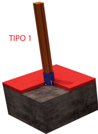
FIJACION A SOLERA DE HORMIGON
