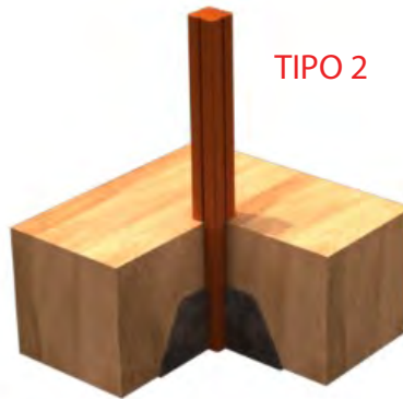
FIJACION A SUELO BLANDO
