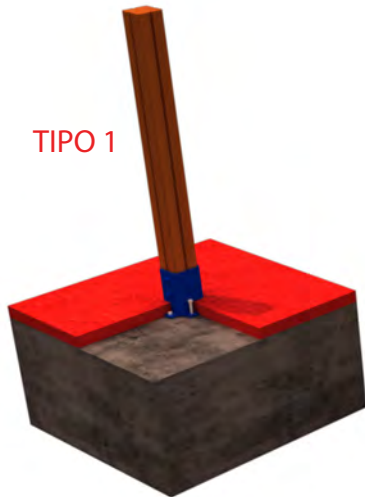
FIJACION A SOLERA DE HORMIGON
