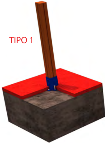
FIJACION A SOLERA DE HORMIGON
