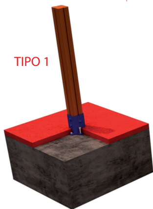
FIJACION A SOLERA DE HORMIGON
